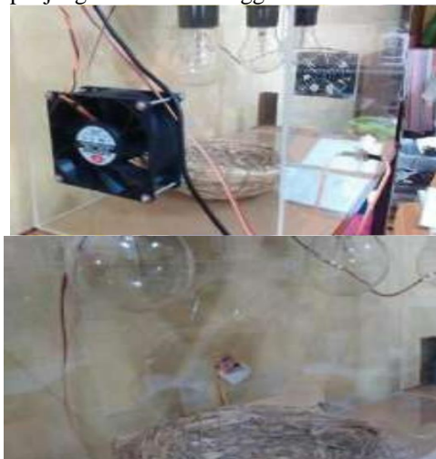
Gambar 6 Penempatan Kipas DC, Lampu dan Sensor DS18B20
