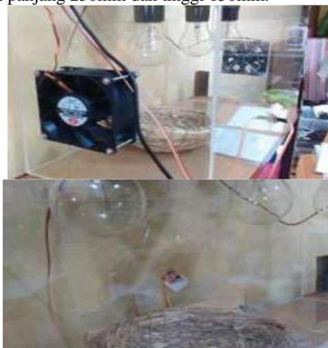
Gambar 6 Penempatan Kipas DC, Lampu dan Sensor DS18B20
